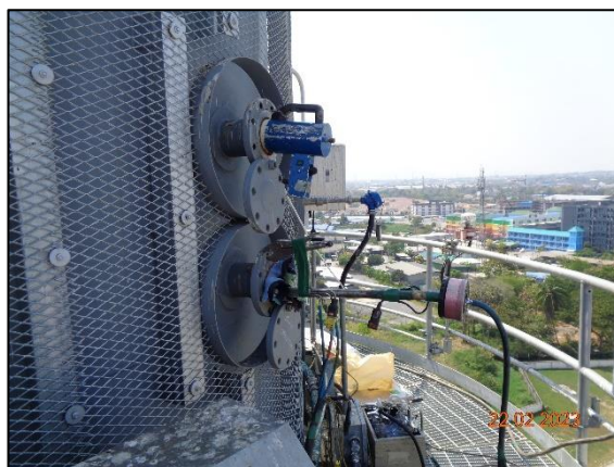
รูปที่ 3-1 การเก็บตัวอย่างคุณภาพอากาศในปล่องระบาย บริเวณ HRSG11
